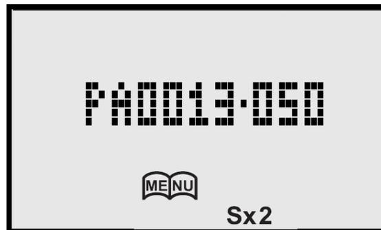
In diesem Beispiel wird die Höchstgeschwindigkeit (PA0013) einer Lok mit einem SelectRIX 2 Lokdecoder vom Standardwert 092 auf den Wert 050 gestellt. Und dies kann über POM geschehen, während die Lok fährt. Die Auswirkung dieser Änderung ist sofort zu sehen.
