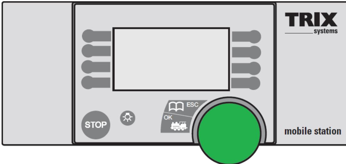
Die TRIX Mobile Station 66920 ist ein kabelgebundener Modellbahn-Fahrregler für das bisherige SelectRIX 1 und für neue SelectRIX 2 System und wird zusammen mit der TRIX Gleisbox als TRIX Systems ausgeliefert. Der originale Auslieferungszustand enthält die Versionen 0.22 oder 0.34. In den Originalversionen können über die Gleisbox SelectRIX 1, SelectRIX 2 und DCC Lokdecoder programmiert und gefahren werden.
