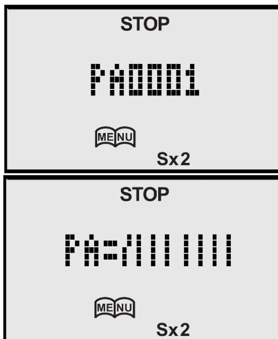
Hier können nun die einzelnen Bits eingestellt werden. Dies geschieht über die Funktionstasten 1 bis 8. Ein Druck auf eine dieser Tasten schreibt den neuen Wert sofort in den Decoder. Ein gerader Strich bedeutet das Bit ist 0, ein schräger Strich bedeutet das Bit ist 1 (also gesetzt). Auch hier muss über die Decoderdokumentation ermittelt werden, was welches Bit im Decoder bewirkt.
