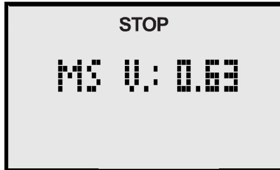
Durch Drücken einer Taste (außer der STOP Taste) an der Mobile Station während des Einschaltens kann diese Anzeige übergangen und damit die Inbetriebnahme etwas beschleunigt werden. Danach zeigt die Mobile Station die zuletzt gewählte Lok an, die dann sofort geregelt werden kann.
