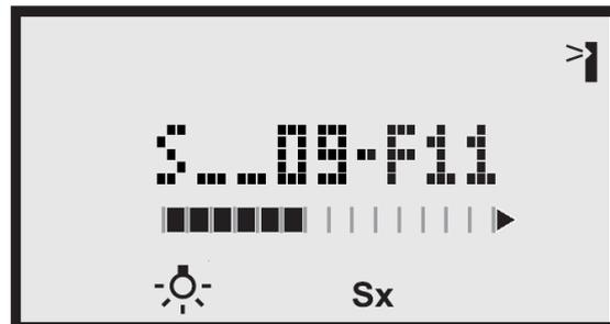
Dieses Beispiel zeigt eine SelectRIX 1 Lok die geregelt wird. Die Lokdecoder-Adresse ist 09, die Fahrstufe 11. Die Funktionen Licht und Horn sind an. Der Fahrstrom ist eingeschaltet (kein STOP Symbol).
