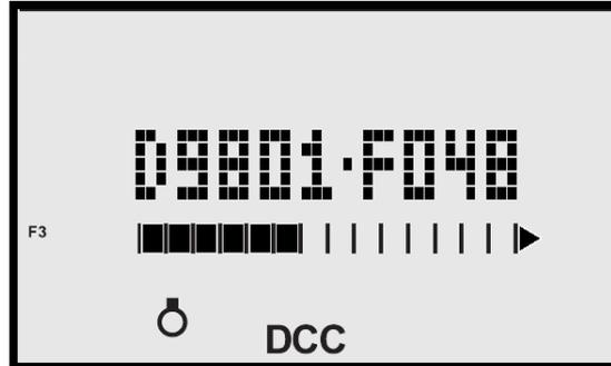
In diesem Beispiel wird eine Lok geregelt, die einen DCC Lokdecoder mit langen Adressen und 126 Fahrstufen hat. Die aktuelle Fahrstufe der Lok ist 048 und die Fahrtrichtung ist vorwärts. Die Lichtfunktion ist aus und die Funktion F3 ist aktiv.
