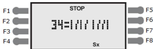
In diesem Beispiel wird der Wert der SelectRIX Bus-Adresse 34 angezeigt und kann über die Funktionstasten F1 bis F8 geändert werden. Links oben ist dabei die Taste 1, links unten die Taste 4, rechts oben die Taste 5 und rechts unten die Taste 8. Wenn diese Adresse einem Weichendecoder zugewiesen (programmiert) wurde, dann werden die an diesem Weichendecoder angeschlossenen Weichen (1 bis 8) dementsprechend schalten.
