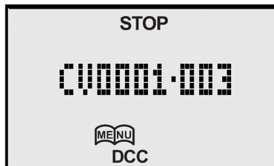
Hier wurde die CV mit der Nummer 0001 ausgelesen und angezeigt. Dieser Wert kann nun geändert werden. Was dieser Wert im Lokdecoder bewirkt und in welchem Bereich er eingestellt werden kann, muss aus der Beschreibung des entsprechenden Lokdecoders entnommen werden.
