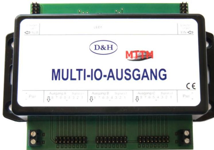
Dieses MULTI-IO-AUSGANG Modul wurde als Erweiterungsmodul entwickelt, um das MULTI-IO-BASISMODUL um jeweils drei achtfache AUSGÄNGE zu erweitern. Dabei wurde auch dafür gesorgt, dass größere Ströme (bis 1 Amp.) als im Basismodul bereitgestellt werden können. Somit können neben LEDs auch Lampen, Spulen, Motoren usw. angesteuert werden. Zudem ermöglicht das MULTI-IO-AUSGANG Modul das Überblenden bei Lichtsignalen.
